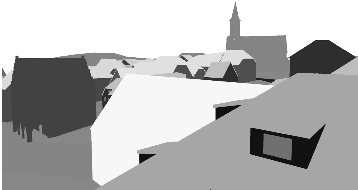
Abbildung 2: Referenzobjekte werden durch eindeutige Nummern unterschieden. Sichtbare Regionen von Referenzobjekten werden dynamisch und bildbasiert ermittelt. Jeder Bildpunkt enthält die Nummer des an dieser Stelle sichtbaren Referenzobjekts. Jeder Farbbereich des Bildes repräsentiert also eine sichtbare Region für ein Referenzobjekt in diesem Bereich.
